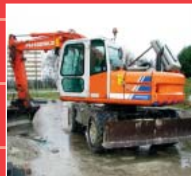
Fiat Hitachi wielgraafmachine/wheel excavator, model: FH130W-3
