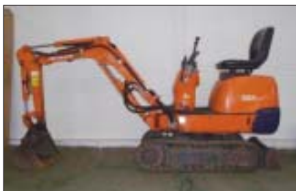
Hitachi mini rupsgraaf machine/mini excavator, model: EX8
