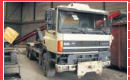
Daf bedrijfsauto, type: 85-360 ATI 6x2, v.v. Multilift containerinstallatie Daf truck, type: 85-360 ATI 6x2, with Multilift container system
