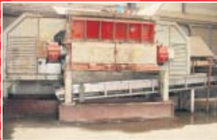
Lindner kunststof shredder, cap.: 4.5 ton/uur, bj.: 2003 Lindner plastics shredder, cap.: 4.5 ton/hr., ymf: 2003
