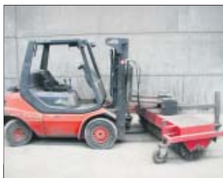
Linde volhydraulische diesel vorkheftruck, type: H25D, bj.: 2000 en 1 Sweep hydraulische vorkheftruck rolveegmachine, werkbreedte: 2.200 mm. Linde full hydraulic diesel forklift-truck, type: H25D, ymf: 2000 and 1 Sweep hydraulic roll sweeper, work width: 2.200 mm.
