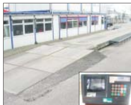
Weegbrug v.v. Toledo digitale display, type: 8520, weegvermogen: max. 70.000 kg., min. 1.000 kg., bj.: 1997 Weighing bridge with Toledo digital display, type: 8520, cap.: max. 70.000 kg., min. 1.000 kg., ymf: 1997
