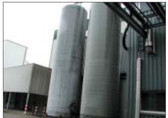
Plasticon vertical plastic tank, cap.: ca. 131.000 ltr., work temp.: 50°C
