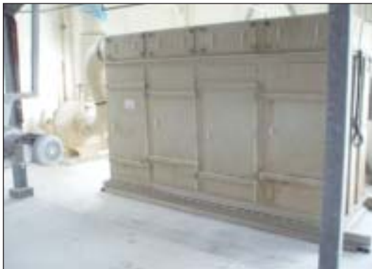
Filter cabinet with pneumatic dust filter unit, 8 inspection hatches, with 1 Kiekens exhaust, type: 8-KSRM-50 Filterkast v.v. pneumatische afklopinrichting, 8 inspectieluiken, met 1 Kiekens exhaust, type: 8-KSRM-50
