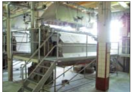
GMF rolling mill dryer, power cap.: 55 kW., with control, mobile waste flour bin with screw conveyor, etc. GMF walsdroger, aandrijvingsvermogen: 55 kW., met besturing, verrijdbare meelopvangbak v.v. schroeftransporteur, etc.
