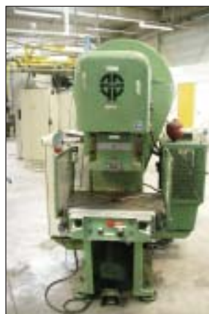
Röcher hydr. C-pers/hydr. C-frame press, model: REP 40-12S, cap.: 40 t.
