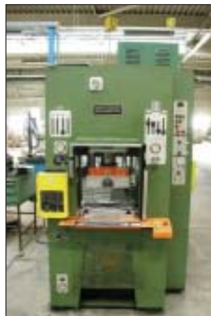
Hans Schoen kolompers/column press, model: SH, cap.: 30 t.
