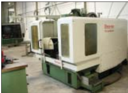
Beaver CNC vert. bewerkingscentrum/CNC vert. machining centre, model: Partsmaster
