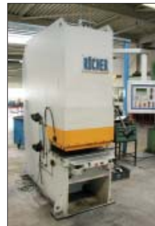
Röcher hydr. C-pers/hydr. C-frame press, model: REP 63-12S, cap.: 63 t.
