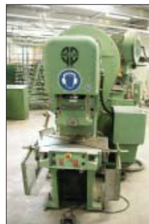
Hans Schoen kolompers/column press, model: SH, cap.: 30 t.
