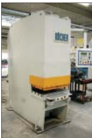
Röcher hydr. C-pers/hydr. C-frame press, model: REP 40-12S, cap.: 40 t.
