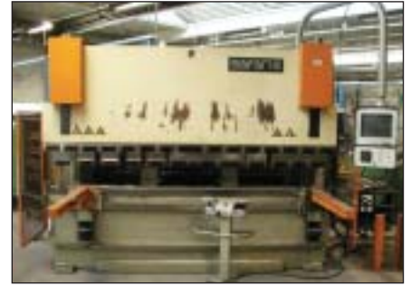
Safan hydr. CNC kantbank/hydr. CNC brake press, cap.: 50 t.
