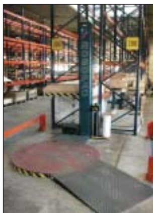
Robopac foliewik- kelmachi- ne/ foil wrap- per
