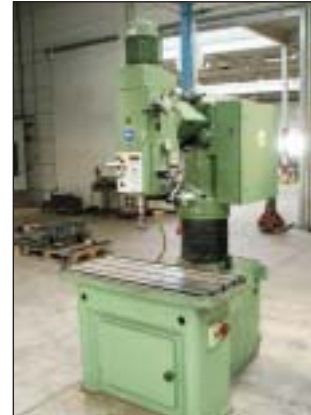
Donau radiaal-boormachine/radial drill, model: DR 32
