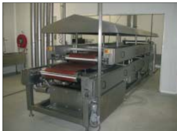
2 stuks Berief rvs doorloop wok lijnen type DUBRA met Wanson Thermoblock thermische olie installatie/ Berief stainless steel passage wok line, model: 2 pcs DUBRA with Wanson Thermoblock thermic oil installation
