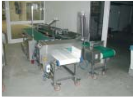
rvs bandtransporteurs met LOMA metaaldetectoren/ stainless steel conveyor with LOMA metal detectors
